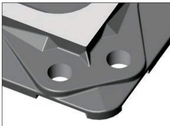
ベースプレート形状例 (Gタイプ、アンカーボルト8本)
