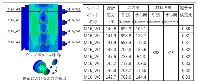
図6 S-RH200N45のボルト部の von Mises コンター、及び、組合せ応力等 (荷重レベル： P_u 、加力方向：押側)
