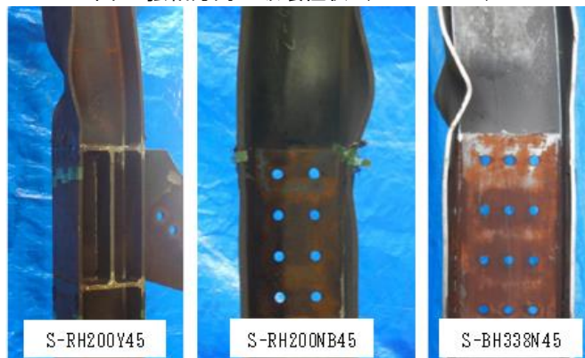
図 8 強軸方向の破壊性状 (接合部, 加力後)
