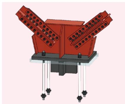
シアコッターハイベース工法（柱脚タイプ、Vプレートタイプ）はコンクリート内部に埋め込むことで大きなせん断耐力を発揮します。また、独自の施工方法により柱型を箱抜きすることで、簡単にシアコッターを埋め込むことが可能です。
