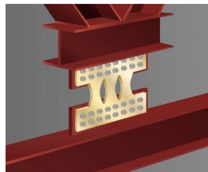
イクステンダムを降伏させることで地震時のエネルギーを吸収し、柱・はりの負荷を軽減、かつ地震の揺れを抑制することができます。交換が容易であり、経済的にも優れたダンパです。
