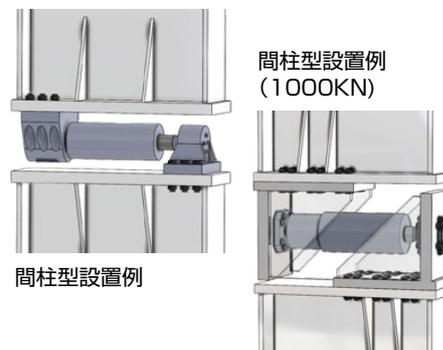
ハイビルダムは油圧を使った減衰力により建物の揺れを低減させる、パッシブ型制震ダンパシステムです。大地震から風揺れまで幅広い範囲で効果を発揮するハイビルダムは超高層建物から低層建物まで様々な建物に採用され、耐震性・居住性の向上に貢献しています。
