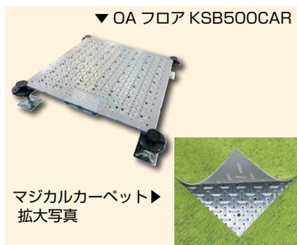
美風は省エネと快適性を向上させた環境配慮型のOAフロアです。表面から孔が見えにくい当社独自の孔加工技術により、一般のタイルカーペット・置敷タイルが床吹出空調用の「マジカルカーペット」に変身。意匠性を損なわずに床吹出空調が実現可能です。
