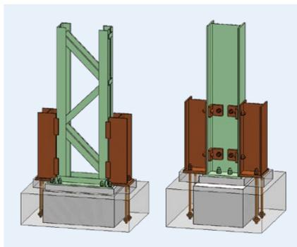
既存鉄骨柱の外側に補強柱と補強アンカーボルトを設置し、柱同士を接合することで、柱脚の曲げ耐力・せん断耐力・靱性指標(F値)を向上させる工法です。コンセプトは「生産性への影響を少なく」。「スマートフィット工法」は旧耐震基準の工場・倉庫の耐震補強に適した工法です。
