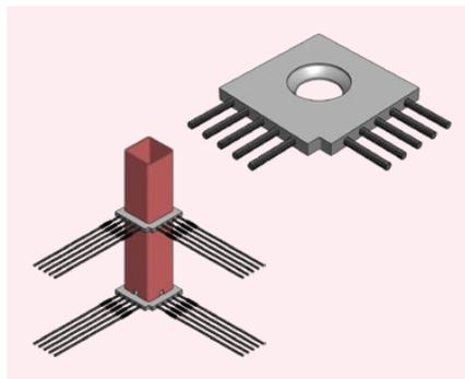
柱脚に基礎梁が取り付けられない側のコンクリートの破壊を防止するために用いるU字補強筋の代替として、ベアリングダイアベース（鋳鋼製のベースプレート及びダイアフラムと補強筋となるねじ鉄筋が一体化された部材）を用いる工法です。
