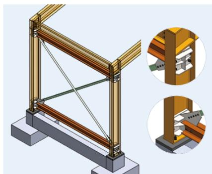
現場での「無溶接」「施工効率の向上」をコンセプトに開発した、無溶接接合法です。引張ブレースのみに対応し、専用のSC金物とボルトでブレース材の設置が可能です。無溶接接合法で火気を使用しないため、火災リスクを大幅に低減できます。
