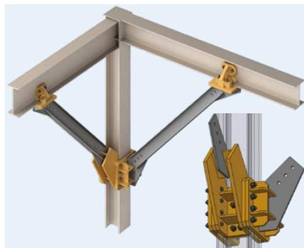
既存材への孔開けはウェブのみでフランジへの孔開けは不要です。弱・強軸の両方向の方杖補強が無溶接かつ同レベルで実現できます。無溶接化によりトータルコストが抑えられます。\*東日本旅客鉄道様、東鉄工業様との共同開発品です。
