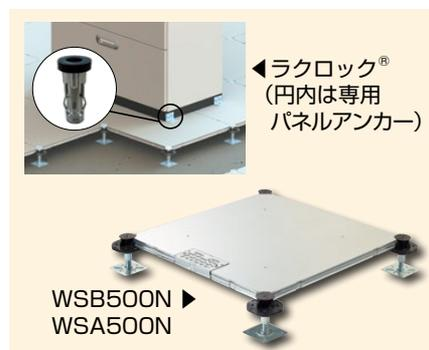
ウッドコア素材によりCO<sub>2</sub>固定化に貢献するエコ商品。軽量で扱いやすく歩行感にも優れています。ラックロックはOAフロアパネルに什器を直接耐震固定できる商品です。専用のパネルアンカーで簡単に固定でき、震度7相当の地震波実験でも安全を実証済みです。
