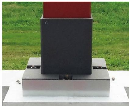
PIN ベース工法は、在来ピン柱脚に比べ回転剛性を小さくしてピン接合に近づけた露出型柱脚です。スリットを設けることでPIN プレートを変形しやすくし、在来ピン柱脚より低剛性を実現いたしました。
