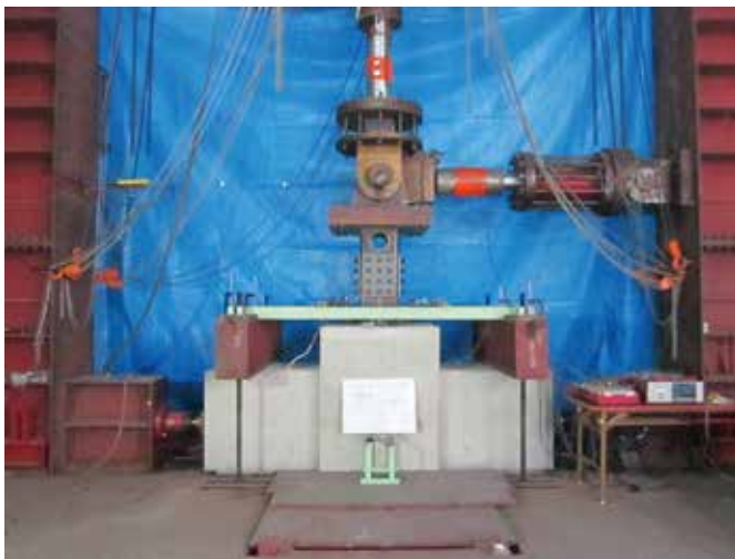
実験風景(杭頭部を逆さまにしてコンクリートに埋め込んでいます)
