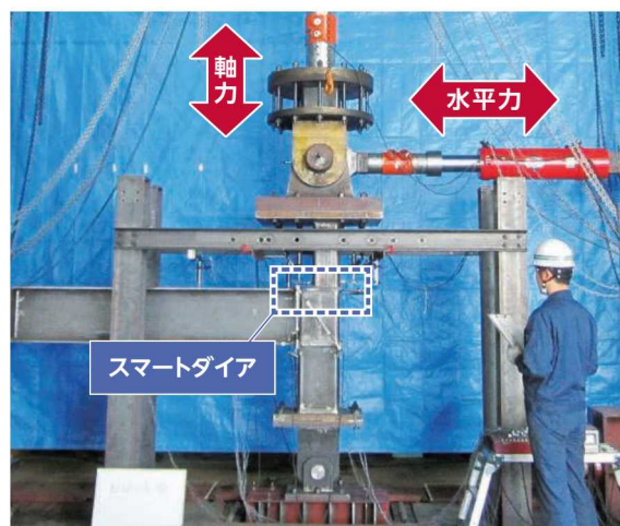
架構モデル実験 (柱はり接合部全体の性能確認)
