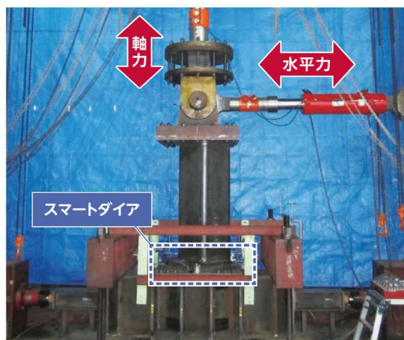
面外曲げ実験 (スマートダイアの曲げ耐力・剛性確認)
