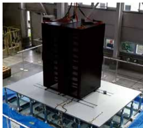
実験時に使用した固定方法
